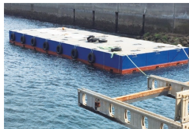
河川の氾濫対策に使用する組立台船(水上での土木工事をスムーズに行うことができる組み立て式の海上建機)
