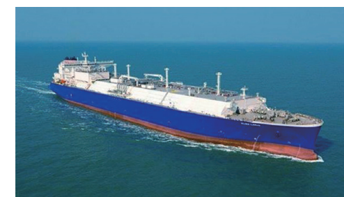
環境負荷低減のためガス燃料も利用可能なデュアルフューエルエンジンを搭載した液化ガス輸送船 (France LNG Shipping S.A.S)
